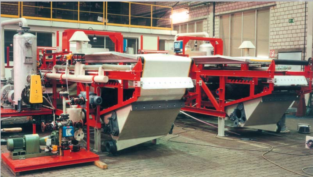
1 Vakuumbandfilter Typ CHF zur Fest/Flüssig-Trennung von Suspensionen in der Chemie, Lebensmittelindustrie, Umwelttechnik
