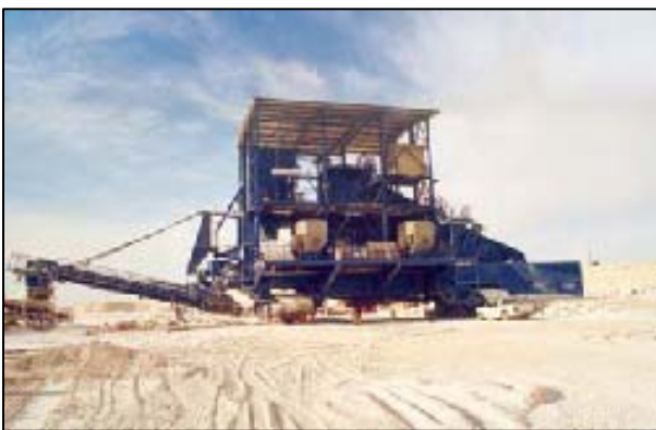
Bild 3: Mobile Brechanlage von ThyssenKrupp Fördertechnik im Werk Ain Dar
